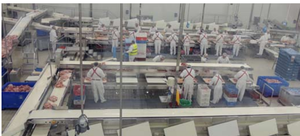
La primera operación que se realiza en la unidad de cocidos es la del deshuesado y limpieza de los jamones y paletas.
